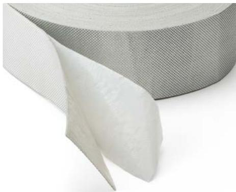
**PRIMATE PHONOJOIN** è un nastro adesivo a basso spessore per giunte, in polietilene espanso a celle chiuse reticolato chimicamente, indicato per la nastratura delle giunzioni e dei sormonti dei materassini. Il nastro è accoppiato sulla faccia superiore con film gofrato in PET alluminato e sulla faccia inferiore con retinatura adesivizzata anti-stretching, a evitare tensioni e ritiri durante le fasi di posa del sistema. Spessore 1,8 mm; altezza 5 cm. Bobine da 50 m.
