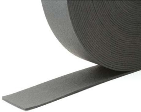
**PRIMATE PHONOCUT** è la fascia tagliamuro per l'isolamento acustico al piede delle murature, in polietilene espanso a celle chiuse reticolato chimicamente ad elevata densità (70 kg/mc). Il materiale possiede una elevata resistenza a compressione ( $\sigma_c = 86$  kPa) e alla deformazione sotto carico costante, pertanto è idoneo in qualunque applicazione come fascia desolidarizzante. Spessore 5 mm; larghezza 10-15-30 cm. Bobine da 50 m.
