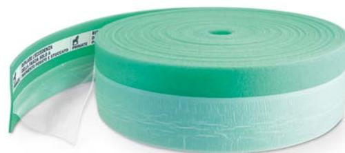
**PRIMATE PHONOPER RD** è la fascia perimetrale adesiva "radiante" specifica per la realizzazione del "massetto galleggiante" in presenza di sistema di riscaldamento/raffrescamento a pavimento, composta da una parte verticale in polietilene espanso a celle chiuse dello spessore di 8 mm e da un velo in polietilene per il sormonto sul pannello radiante. Disponibile con altezza 15 cm. Bobine da 25 m.
