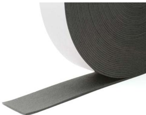
Nastro adesivo per il disaccoppiamento delle strutture metalliche di pareti in cartongesso, in polietilene espanso a celle chiuse reticolato chimicamente, spessore 3,5 mm. **PRIMATE PHONONASTRO CG** è disponibile nelle versioni monoadesivo e biadesivo, in due altezze rispettivamente di 50 mm e 75 mm. Bobine da 20 m.
