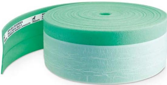
**PRIMATE PHONOPER** è la fascia perimetrale adesiva per la realizzazione del "massetto galleggiante", in polietilene espanso a celle chiuse, con apposita "fresata" per una posa facilitata ad "L". Spessore 5 mm. Disponibile con altezza 20 cm. Bobine da 50 m.
