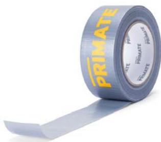
Banda adesiva di guarnizione per migliorare la tenuta all'acqua dei punti di fissaggio dei contro-listelli sugli SMT. Si incolla sui contro-listelli sottostanti ai listelli porta-tegola prima della loro messa in opera sul supporto. Ideale soprattutto per tetti a pendenza ridotta.
