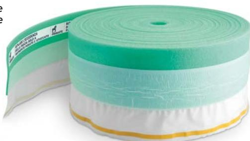
**PRIMATE PHONOPER DS** è la fascia perimetrale adesiva a "doppio spessore" per la realizzazione del "massetto galleggiante", composta da una parte verticale in polietilene espanso a celle chiuse dello spessore di 6 mm, e da una parte orizzontale in HDPE dello spessore di 100 µm con fascia adesiva sull'estremità inferiore. Disponibile con altezza totale 25 cm. Bobine da 50 m.
