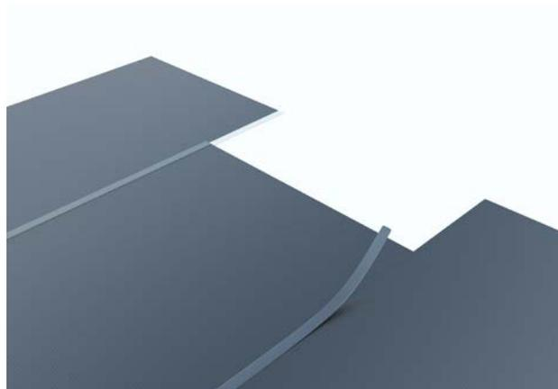
*Si ricorda che per un adeguato risultato acustico la posa dei teli anticalpestio, specificamente studiati per il sistema di riscaldamento radiante a pavimento, è necessaria, in quanto i soli pannelli non hanno valori di rigidità dinamica adeguati a far funzionare correttamente il sistema "massa-molla-massa".*
